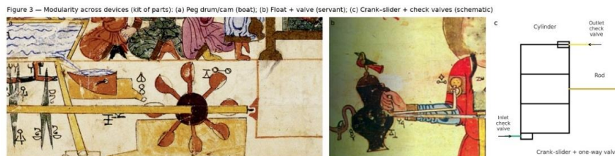
شکل ۳. مدولاریتی اجزا در دستگاه‌های جزّری: (a) درام میخ‌دار/بادامک (قایق نوازندگان)، (b) شناور و ولو (خدمت‌کار آبریز)، (c) میل‌لنگ-شاتون با شیرهای یک‌طرفه (بازترسیم شماتیک). ۲
