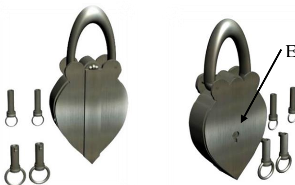
شکل ۶، جلو و پشت قفل نافی با چهار کلید، سوراخ کلید اصلی زیر درپوش قرار می‌گرفته است
